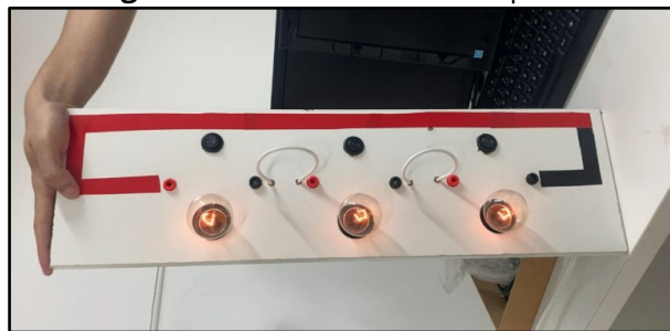
Figura 2. Circuito série de lâmpadas
