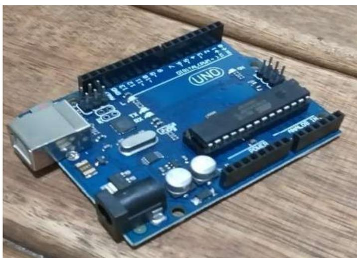
*Arduino UNO R3 – microprocessador Atmega 328. Com essa placa programável é possível controlar e ler periféricos, tais como, sensores e motores, através de entradas (I/O) analógicas e digitais.*
