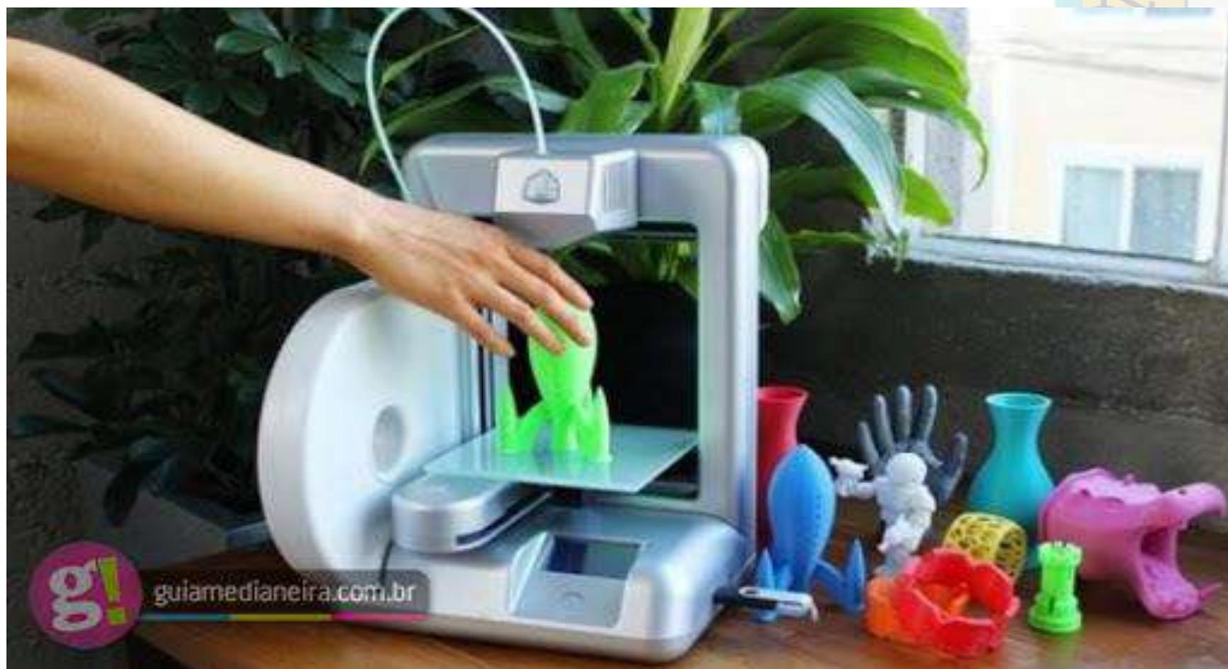
**A Impressão 3D, também conhecida como prototipagem rápida ou manufatura aditiva, é uma forma de tecnologia de fabricação aditiva onde um modelo tridimensional é criado através de sucessivas camadas de material.**
