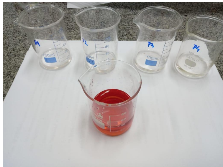
Figura 1. Avaliação preliminar de ferro nas águas amostradas na coleta 1. Os béqueres de trás, a solução incolor indica a ausência de ferro nas amostras.
