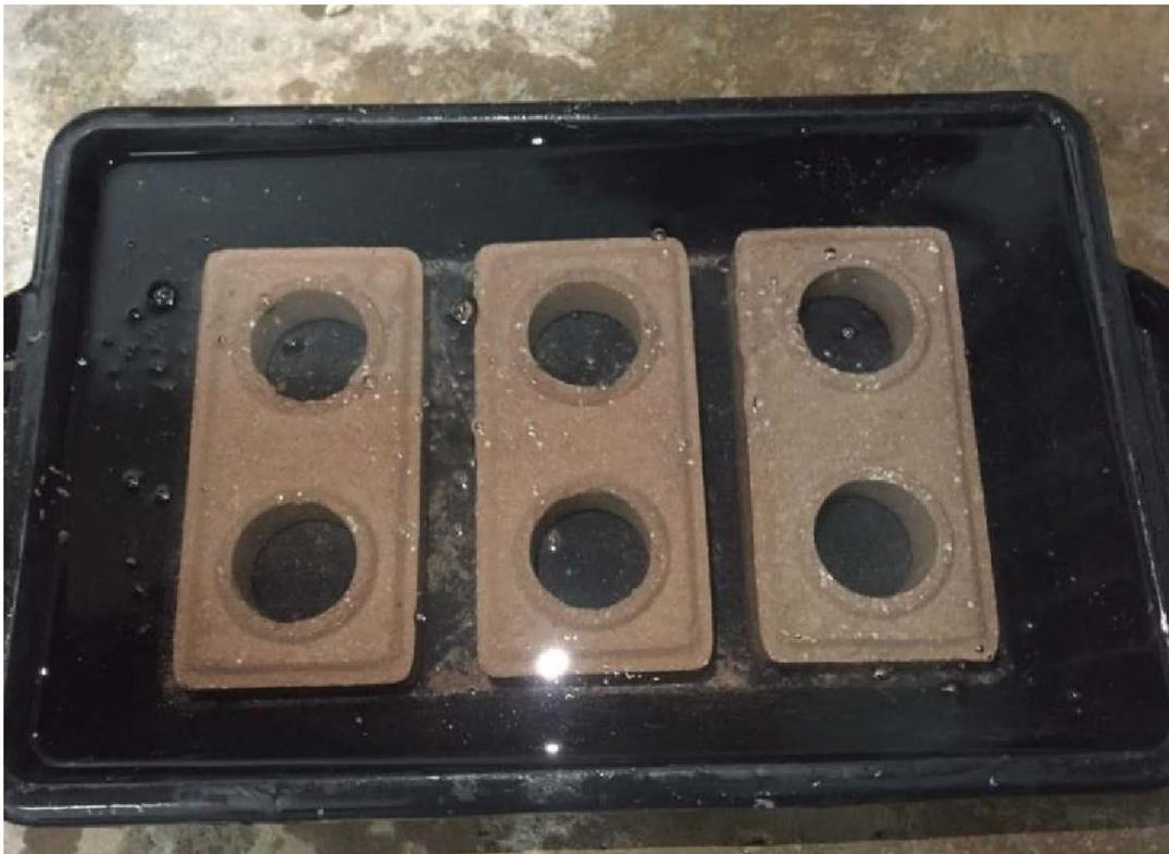
**Figura 2:** Blocos imersos em água.
