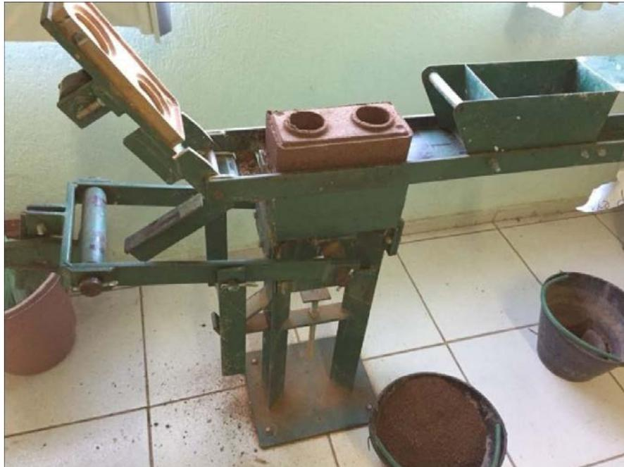
**Figura 1:** Prensagem do Bloco.
